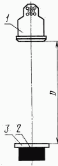
1 — ультрафиолетовый облучатель; 2 — датчик; 3 — светофильтр
